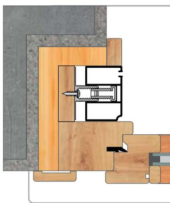
Nel caso in cui non si disponga di 50 mm di incasso, allora è possibile richiedere questo compensatore più basso. Grazie alla sua funzione telescopica, permette anche di compensare da 34 a 48 mm e mediante il suo blocco di sicurezza, non consente all'utilizzatore finale di modificare accidentalmente la vostra regolazione. Questo piccolo dettaglio vi permette di assicurare un'installazione a regola d'arte.
