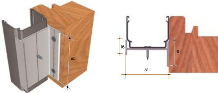
Il compensatore in alluminio risolve brillantemente la problematica di installazione in presenza di avvolgibili in monoblocco con ciellino ispezionabile dall'esterno, in quanto consente di ancorare la parte superiore della zanzariera direttamente sul serramento.
