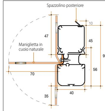
**Compensatore e guida montata.**
