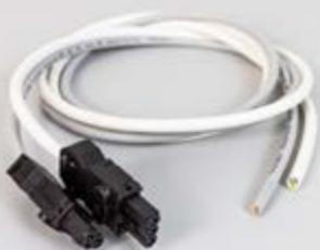
Con Neoscenica Motorizzata vengono forniti 2 cavi da 4 mt (per l'alimentazione e la domotica) dotati di connettori che semplificano il processo di installazione. Dopo aver installato la zanzariera in corrispondenza dei corrugati appositamente predisposti, l'elettricista dovrà solo collegare l'alimentazione e, se necessario, l'impianto domotico per rendere la zanzariera immediatamente operativa.
