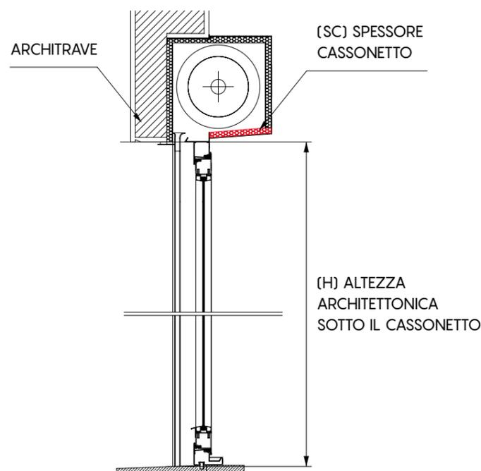
Per la determinazione dell'altezza finita, alla misura dell'altezza architettonica sotto cassetto H, aggiungere 10 cm fino ad un SC di 5 cm (H + 10 cm).
