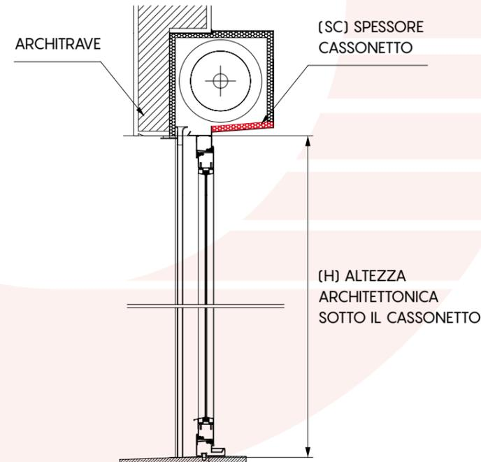
Per la determinazione dell'altezza finita, alla misura dell'altezza architettonica sotto cassonetto H, aggiungere 10 cm fino ad un SC di 5 cm (H + 10 cm).
